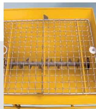
Благодаря низкой посадке облегчается заправка большого бункера смесителя непрерывного действия.
